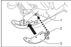
▶ 1. Pipe 2. Groove 3. Wire guide B
