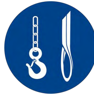
Erlaubte Anschlagmittel: Haken und Lasthebeband.
