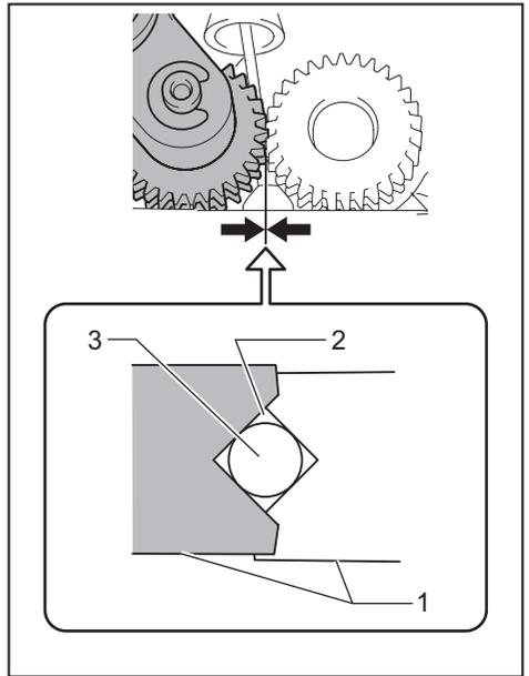
► 1. Gear 2. Path of the wire 3. Wire
